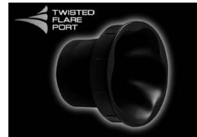
A porta e o gabinete ressoam em uma frequência que é determinada por suas dimensões e forma. Por outro lado, a turbulência no fluxo de ar no final da porta contém uma ampla gama de componentes de frequência que não estão presentes no sinal de entrada. Este ruído ocorre porque a ampla gama de componentes de frequência inclui componentes que correspondem às frequências de ressonância da porta e gabinete, causando forte ressonância.
