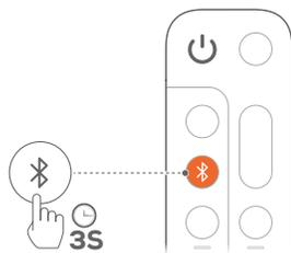
1. Na fonte Bluetooth, pressione e segure **←** na soundbar ou **⏮** no controle remoto até que **“BT PAIRING”** seja exibido.
