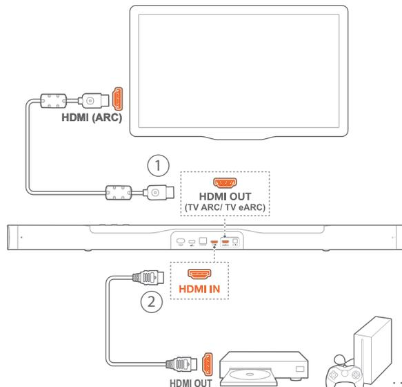
1. Certifique-se de que a soundbar foi conectada corretamente à sua TV e dispositivo digital (consulte [“5.1 Conexão com sua TV e dispositivos digitais”](#)).
