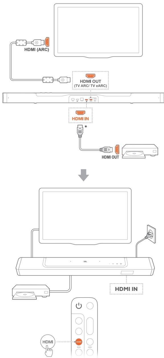
1. Conecte a soundbar com o conector **HDMI IN (ARC / eARC)** na sua TV usando o cabo HDMI fornecido.
