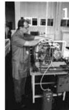
**Colocar o sensor do termômetro na saída do condensador para ser medido o sub-resfriamento**
