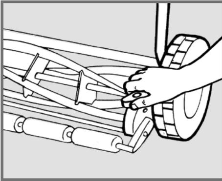
5. Ajuste o cabo na posição ideal para operá-lo. O ajuste da faca de corte é feito girando as borboletas no sentido horário de forma que fique bem próxima dos cortadores rotativos.
