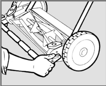
6. Para regular a altura de corte, puxe o braço de ajuste para fora da lateral de forma que os pinos possam ser removidos um a um, para os furos escolhidos da lateral. Este ajuste varia de acordo com a altura e a quantidade de grama.
