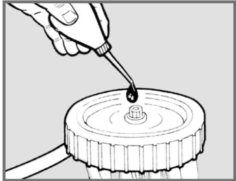
7. Lubrifique com frequência o cortador com óleo SAE 30 ou 40. Tire a calota da roda, o pino de segurança, a roda e a engrenagem catraca. Deixe correr um pouco de óleo no eixo do rotor para que ele escorra até o rolamento. Na hora de montar, não vire a palheta da catraca, nem troque as engrenagens de um lado para outro.
