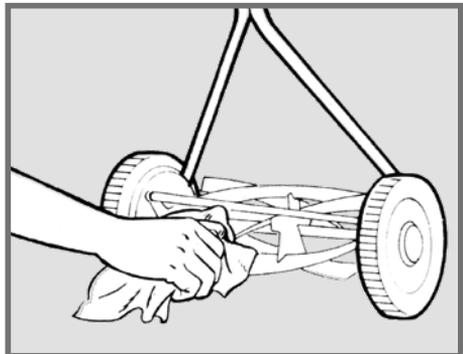
8. Para garantir melhor desempenho e durabilidade, abrigue-o em local seco e protegido das intempéries e faça uma limpeza geral após o uso.
