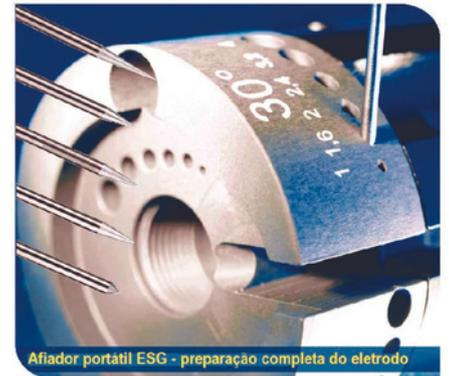
Afiador portátil ESG - preparação completa do eletrodo
