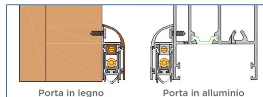
• **CARATTERISTICHE** Meccanismo (BREVETTATO) con la discesa parallela del profilo mobile con guarnizione, caratterizzato dalla DOPPIA REGOLAZIONE (vite E : discesa - vite R : Inclinazione) per una forte pressione omogenea su tutta la lunghezza.
