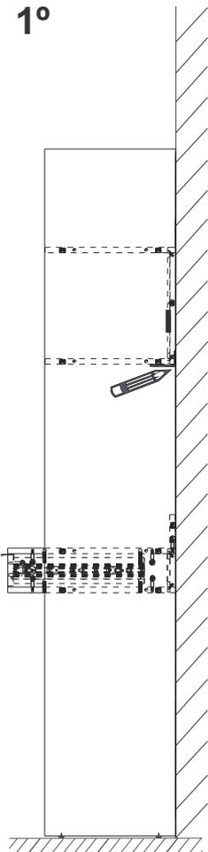
Encostar a Estante na Parede e posicionar a cantoneira, fazendo uma marcação conforme detalhe abaixo
