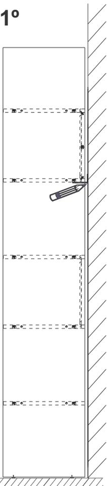
Encostar a Estante na Parede e posicionar a cantoneira, fazendo uma marcação conforme detalhe abaixo
