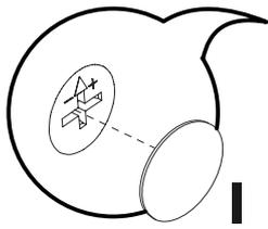
Após a Montagem colar todos os Tapa Furos para melhorar o acabamento do produto.
